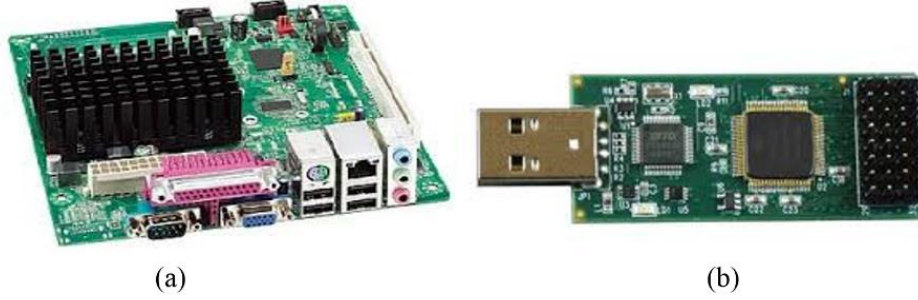
Şekil 6. a)Intel Blkd2500hn gömülü sistem kartı [22]. b) F28069 Piccolo Controlstick [21].
