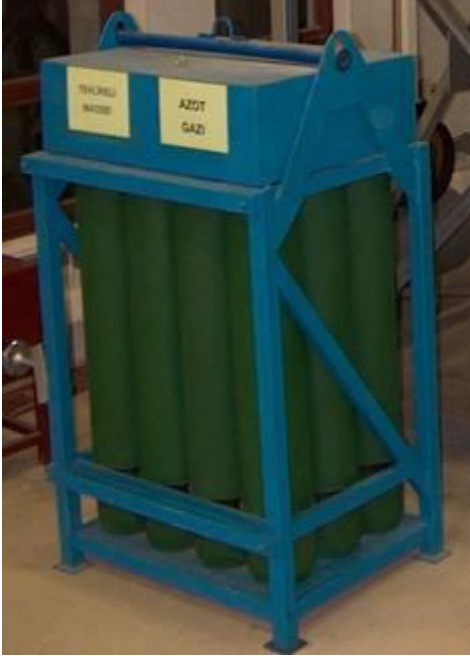
Şekil 3. Gaz kaynağı olarak kullanılan 12'li azot paleti (a) ve argon tüpleri (b).
