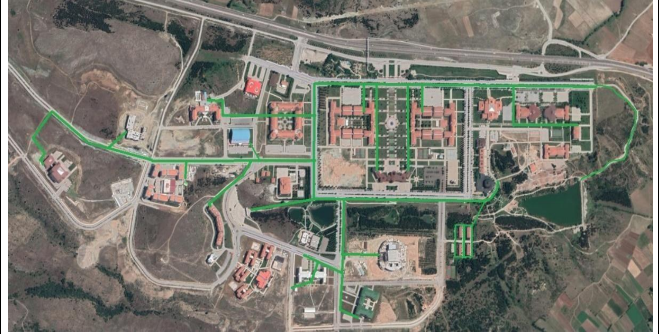
Yağmur Suyu Toplama Boru Hatları (Kütahya Dumlupınar Üniversitesi, Türkiye)
