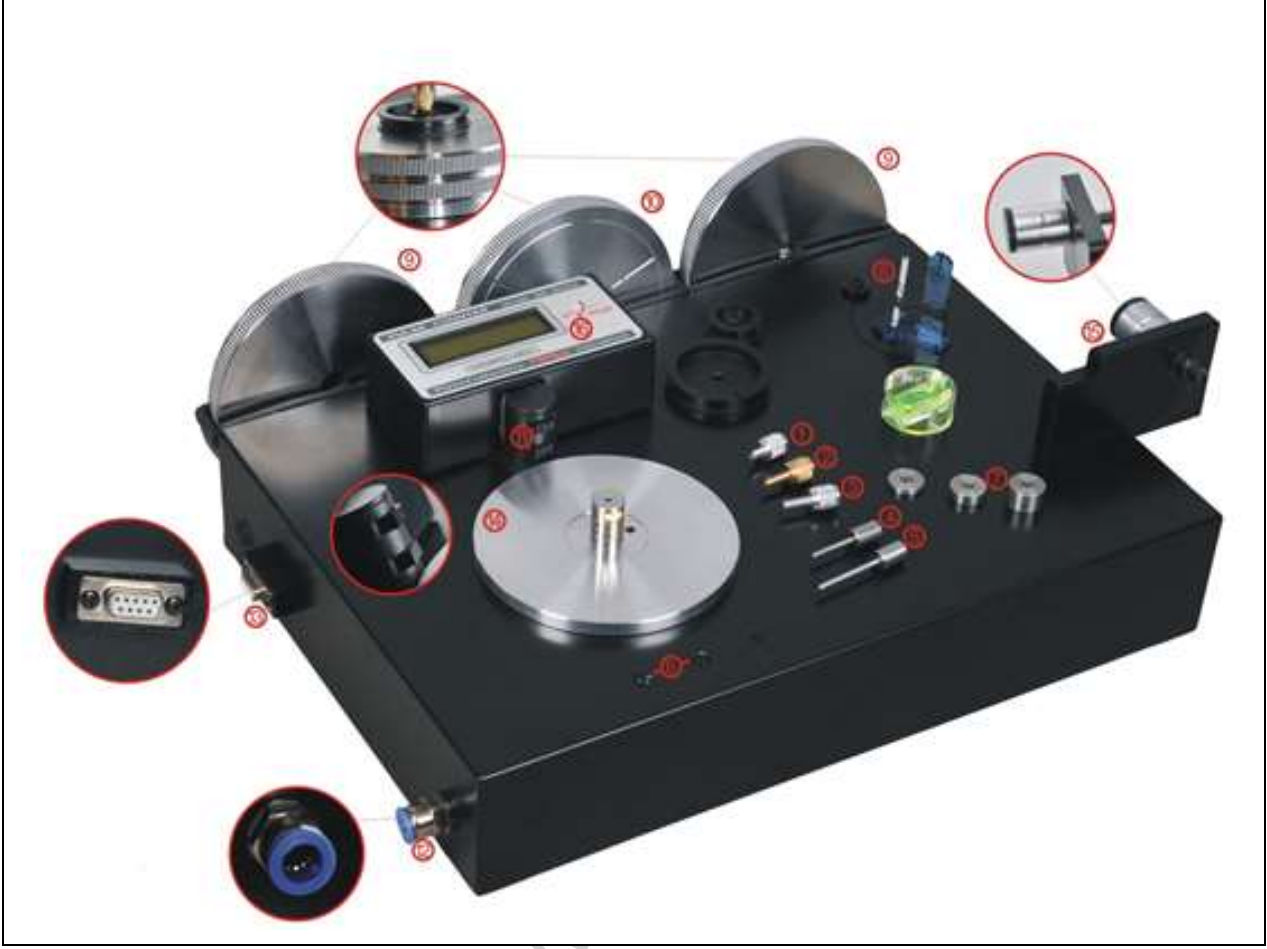
Şekil-17: Deney düzeneğinin üstten görünüşü. İki çelik disk ve bir alüminyum disk sırasıyla "9" ve "10" olarak gösterilmektedir.
