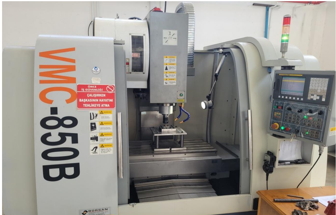
Şekil 3. 1: Artımlı şekillendirme operasyonunda kullanılan dik işleme merkezi
