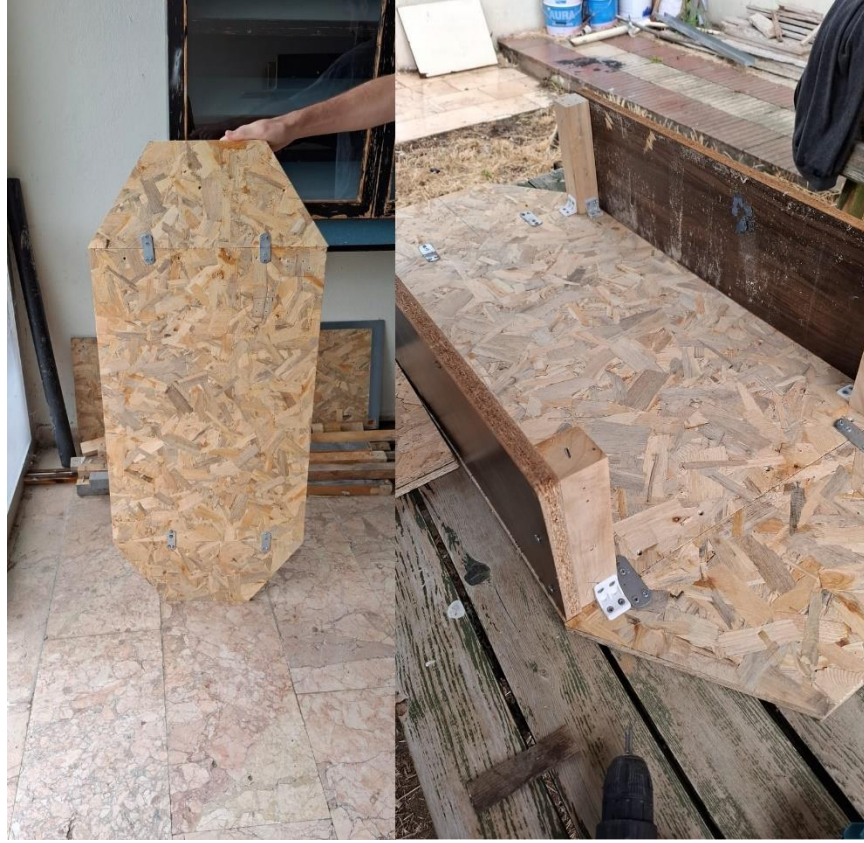
Şekil 22 OSB Levhanın kolektör tabanını oluşturma için hazırlanan düzene
