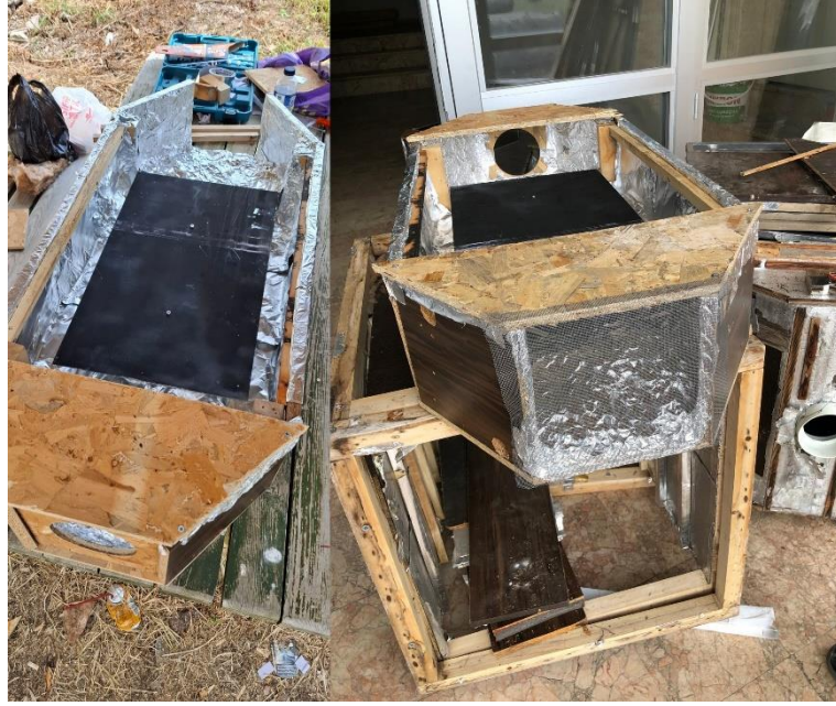
Şekil 24 Alüminyum folyo, emici plaka ve üst muhafaza montajı
