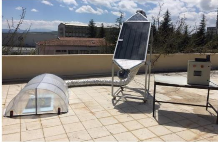
Şekil 8: HGK destekli sera kurutma sistemi
