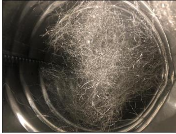
Şekil 2: Isıtıcının içine konumlandırılmış alüminyum yün
