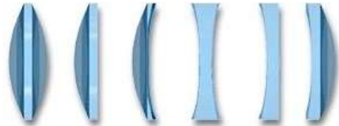
Şekil-40: (a) bikonveks mercek, (b) bir kenarı düz-dışbükey mercek, (c) içbükey-dışbükey mercek (d) bikonkav mercek, (e) bir kenarı düz-içbükey mercek (f) dışbükey-içbükey mercek.
