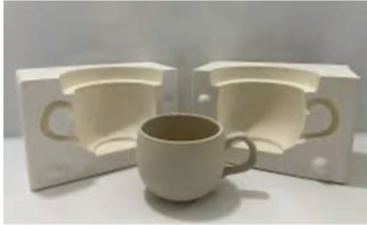
Görsel 1. Alçı Kalıba Slip Döküm İle Şekillendirilmiş Yarı Yaş Seramik Ürün Örneği
