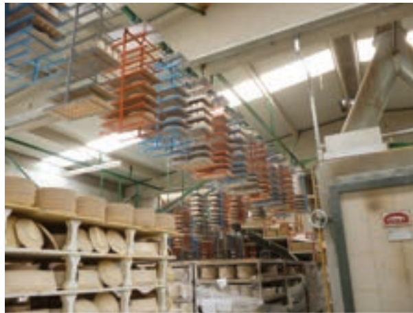
Görsel 6. İşletme Alanı İçindeki Salıncaklı Kurutma Örneği
