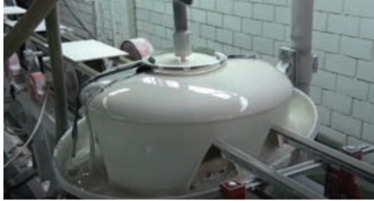
Görsel 15. Seramik Karoların Akıtma Yöntemi ile Sırlanması Örneği
