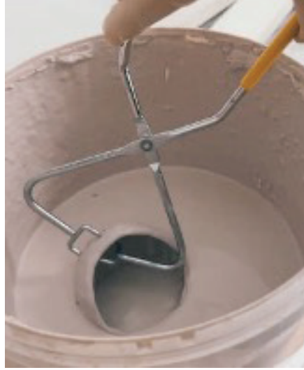
Görsel 12. Bisküvi Ürünün Daldırma Yöntemi ile Sırlaması Örneği
