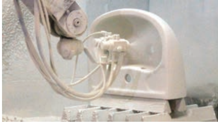
Görsel 14. Endüstriyel Bir Ürünün Püskürtme Yöntemi ile Sırlanması Örneği
