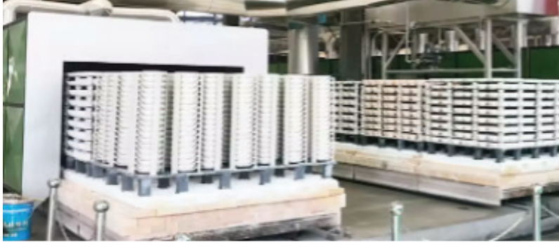
Görsel 4. Sürekli Tünel Kurutma Örneği
