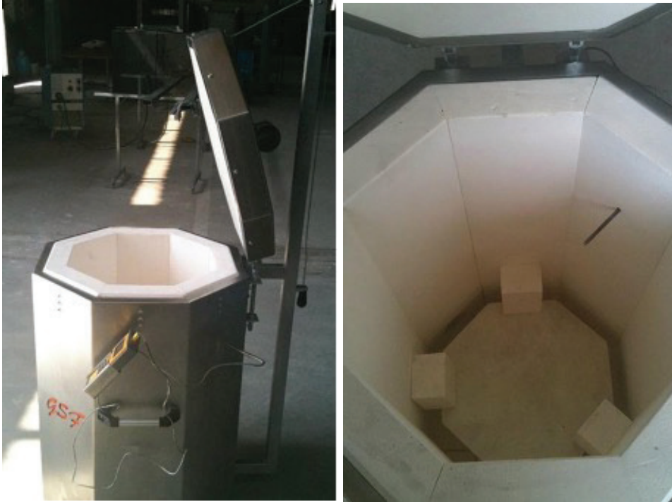
Görsel 2. Üstten yüklemeli raku fırını
