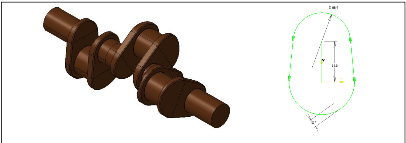
Şekil 4: Krank Mili CAD ve Çizim Aşaması
